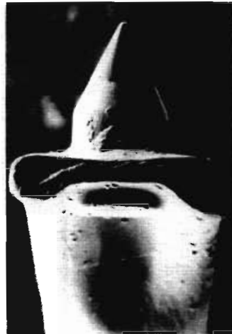
Originele naald voor het Philips element 22 GP 400'', respectievelijk 50 en 1250 maal vergroot. De diamant is niet groter dan strikt nodig en is correct bevestigd met een spaarzaam gebruik van lijm. Het is onder meer het geringe gewicht van deze naald waaraan het 22 GP 400'' element zijn uitstekende spooreigenschappen dankt.
