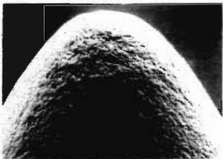
Te grote diamant. Diamant en schacht zijn schuin in de houder gemonteerd. Slechte demping door gebruik van verkeerd materiaal. Deze gebreken leiden tot slechte spooreigenschappen. De tip is overigens correct geslepen.
