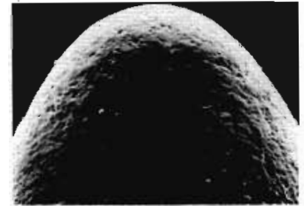
Originele naald voor het Philips element 22 GP 400'', respectievelijk 50 en 1250 maal vergroot. De diamant is niet groter dan strikt nodig en is correct bevestigd met een spaarzaam gebruik van lijm. Het is onder meer het geringe gewicht van deze naald waaraan het 22 GP 400'' element zijn uitstekende spooreigenschappen dankt.
